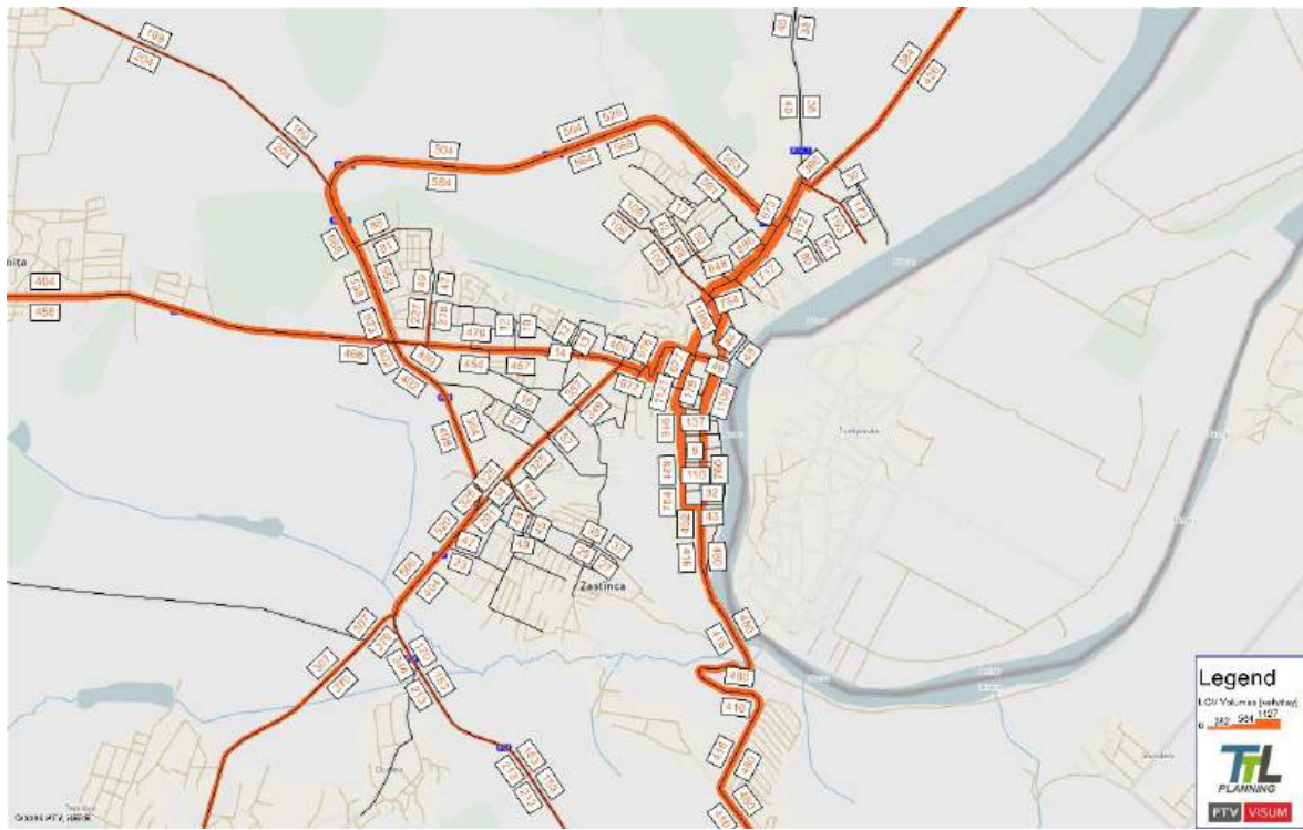
Figura50 . Alocarea cererii de transport pe rețea - Vehicule grele de marfă [veh/zi]
