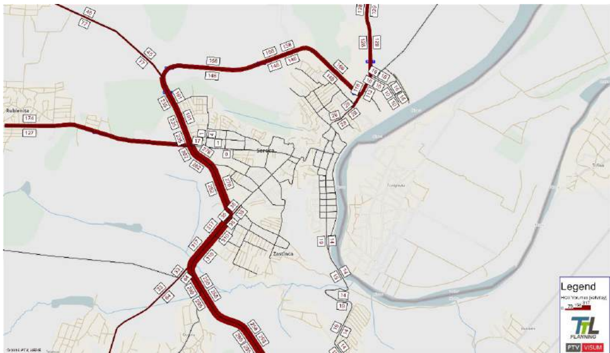
Figura38 . Alocarea cererii de transport pe rețea - Vehicule ușoare de marfă (LGV) [vehicul/zi] - 2024
