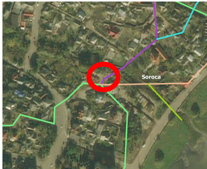
Figura 11: Harta cu conducta DN 250, cu probleme minore de capacitate, în strada Alhionie.
